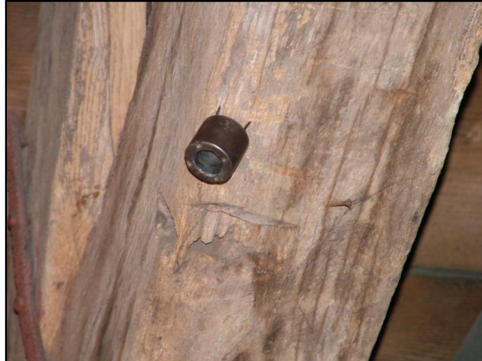
Door de ring wordt een monster geboord vanaf de wankant (intakte buitenkant) naar het hart van de boom.
