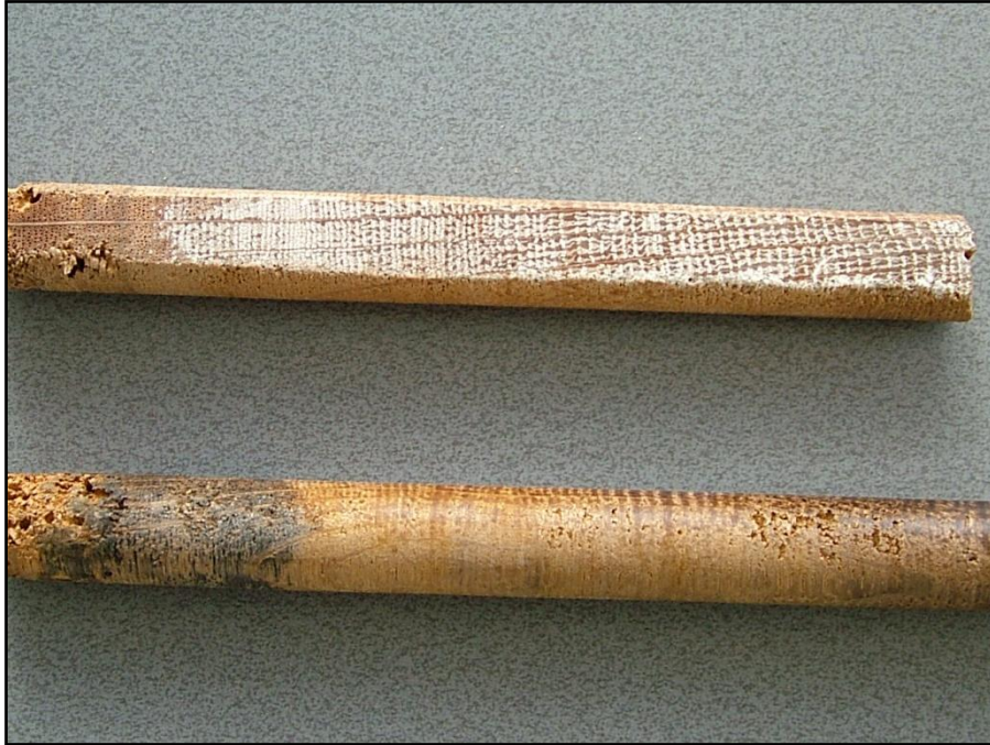
Het bovenste monster is vlak gesneden en van krijt voorzien; het onderste is nog onbehandeld. Het spint zit links.
