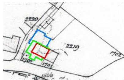
Figuur 11. Hulpkaart sectie B nr 190, april 1906. Het geheel kreeg het nieuwe nummer 2219. Het bovenste blokje zou een fietsenstalling of afdak op de ommuurde speelplaats kunnen zijn. In deze tekening zijn 3 bouwfasen te onderscheiden: rood 1867, groen 1883, blauw 1906
