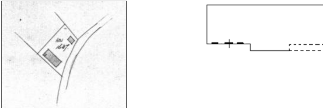
Figuur 2. Hulpkaart sectie B, nr 55, 4-4-1859 (links), waarbij nr 162 werd vernummerd tot 1647. De inspringende hoek werd opgevuld. Rechts de meer waarschijnlijke versie van de toestand na de verbouwing, waarbij het onzeker is of de grote deuren aan de zuidkant in de schuur (zie fig. 4) al waren aangebracht..
